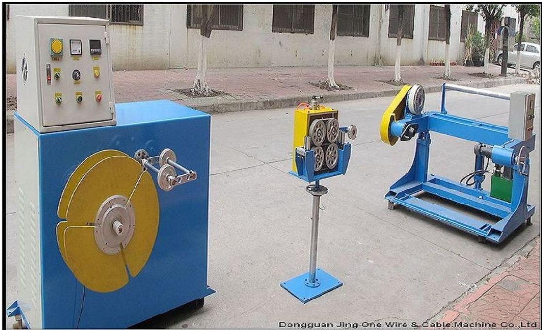
大截面自动排线成圈机打扎机适用于 50-240mm<sup>2</sup> 单只电线及线径小于 30mm 圆形护套线的成圈及打扎。由放线架、高精度计米器与大截面自动排线成圈机主机三部分组成。
