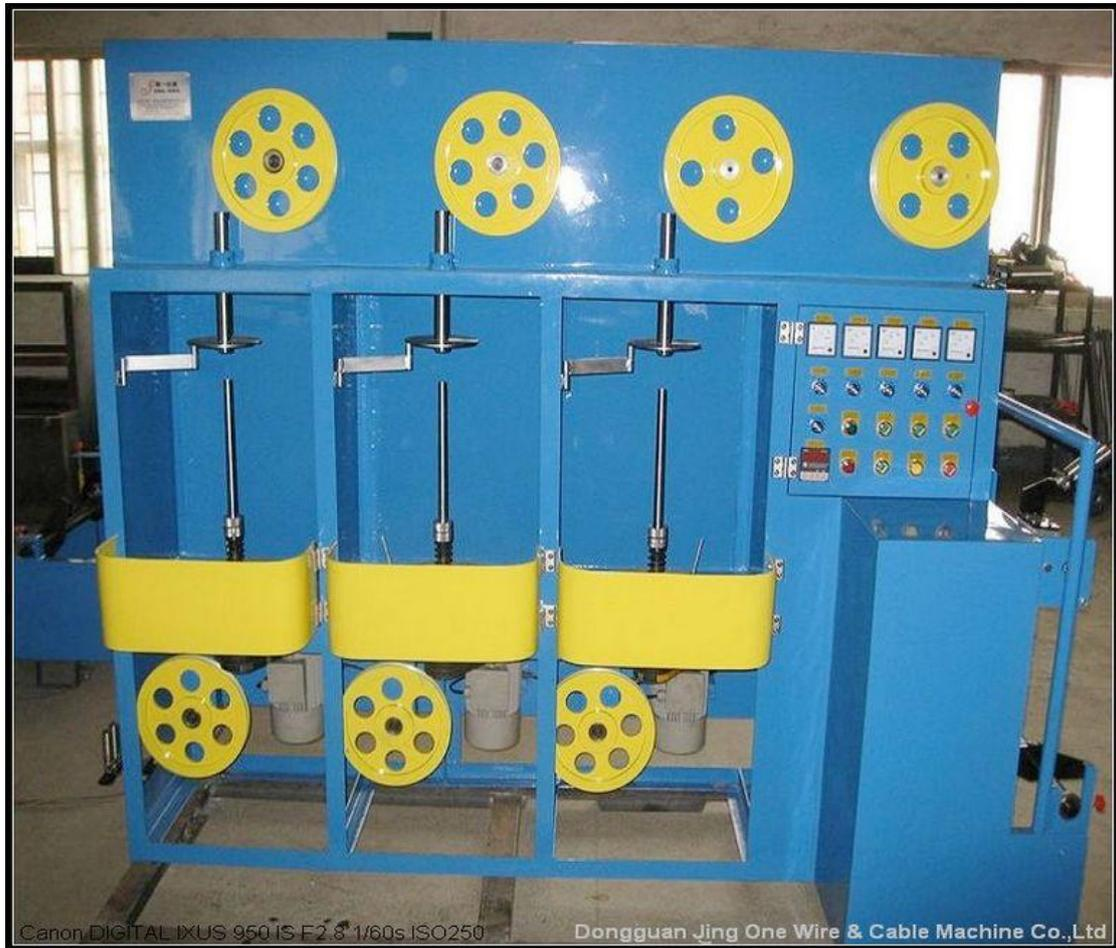
用途：本机为立式三层包纸机，将包带(纸带、铝箔等)通过转盘旋转，绕包在芯线上，具有单绕包头。主要用于电线、力缆、控缆、光缆等绝缘线芯的云母带绕包，耐火电线电缆主要适用于电厂、机场、船舶、高层建筑、地铁、地下街和娱乐场所等地方。本机热销巴基斯坦，乌兹别克斯坦，迪拜。
