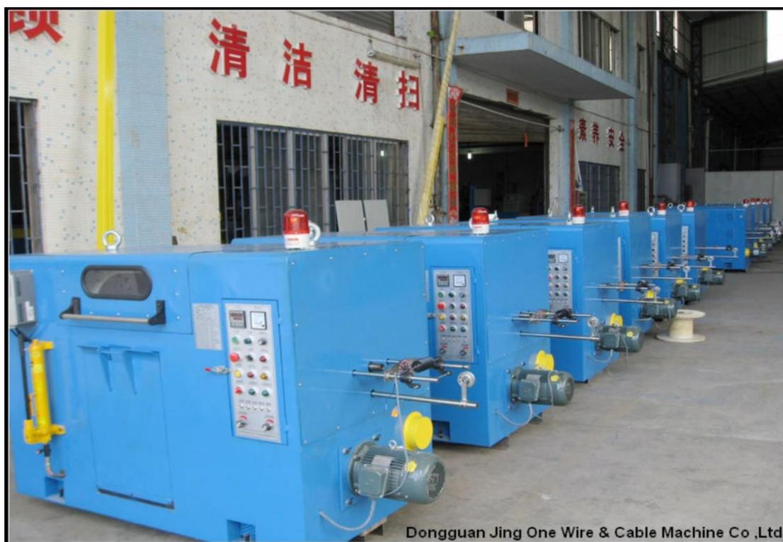
JO-φ250-φ300A-φ500A-φ630A-φ800A 自动高速绞线机适用于多股铜线，铜包钢线，镀锡铜线，镀银铜线。也适合电脑排线、耳机线、电子线、电话线、汽车线、网路线、PVC 线的绞合。
