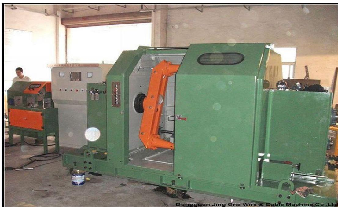
用途： 主要用于绞合超五类线，通信电缆，控制电缆等高频线及中心包带或侧放包带。
