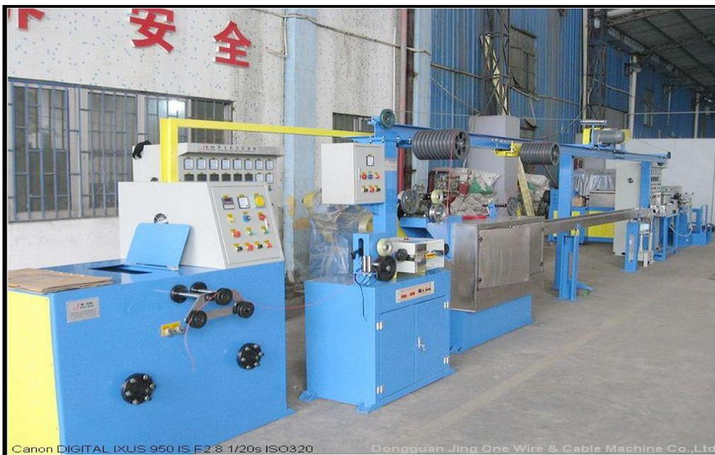
**用途:** 适宜 PVC、PE 等塑料挤出，主要用于电源线、电脑线、绝缘线护套、建筑线等生产。
