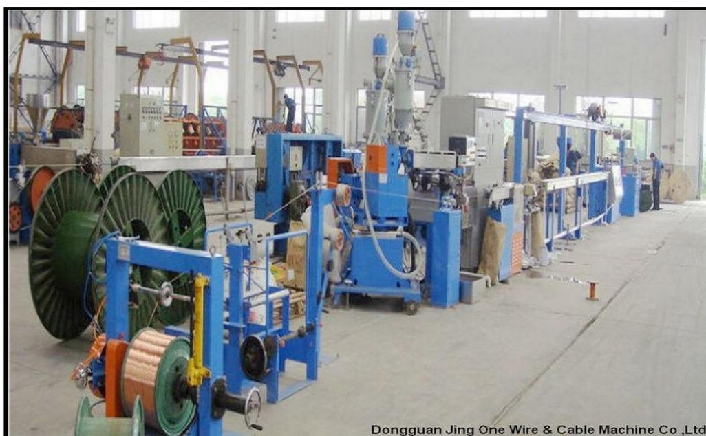
用途：适宜 PVC、PE 等塑料挤出，主要用于 BV、BVR 绝缘护套等生产。
