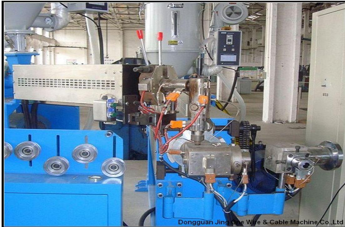
用途：适宜 PVC、PE 等塑料挤出，主要用于电源线、电脑线、绝缘线护套、建筑线等生产。设备组成：由双头日式放线架、校直机、主机、主控柜、水槽、储线架、牵引机、收线机等组成。选配主动式放线架、铜线预热器、过粉机、低烟无卤专用螺杆、低密度螺杆、高密度螺杆、镭射测径仪及 PLC 电脑全程控制。
