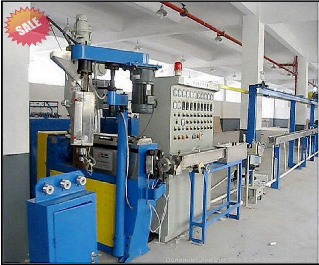
一、用途：适用于 PVC、LDPE、XLPE、LSHF、TPU 等绝缘材料的电线电缆单色、双色、双层、三层挤出作业。
